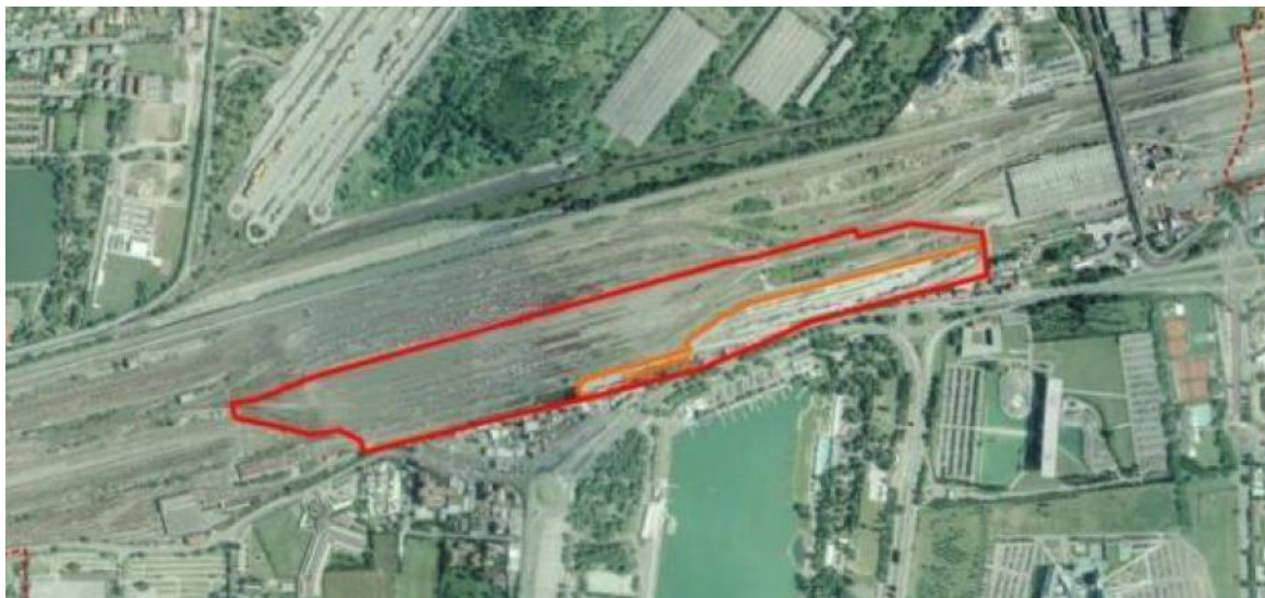
Figura 3-9 – Confronto tra l'area occupata dal terminale intermodale esistente (arancio) e quello in progetto (rosso) (Fonte: Progetto definitivo del Terminale intermodale Milano Smistamento a Segrate STUDIO DI IMPATTO AMBIENTALE)
